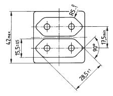
Bezeichnung eines Adapters mit zwei Steckdosen 2,5 A 250 V:
